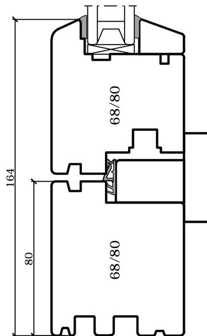
Nur mit einfacher Dichtung möglich
